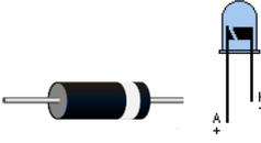
Dioden und auch Leuchtdioden sind gepolte Halbleiterbauteile und lassen den Strom nur in eine Richtung – von der Anode (+) zur Kathode (-) - fließen, wenn an der Anode + und an der Kathode – angelegt wird (Durchlassrichtung). Wird die Diode umgekehrt angeschlossen, fließt praktisch kein Strom. Also auf richtige Polung achten!
